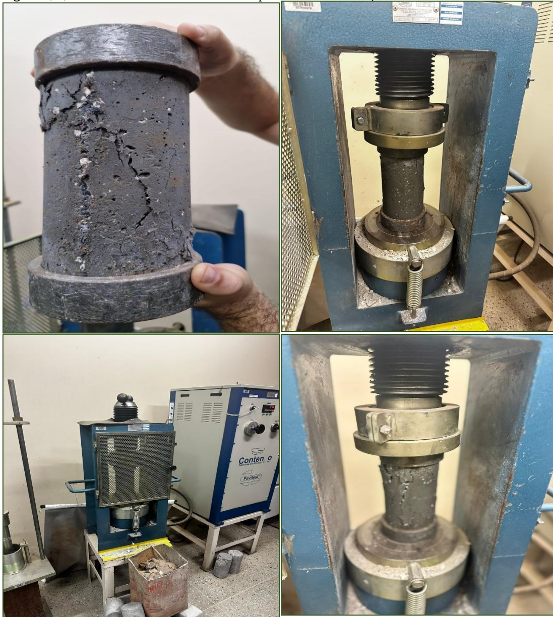
Figura 7, 8, 9 e 10. Ensaio de resistência à compressão realizado na prensa hidráulica.
